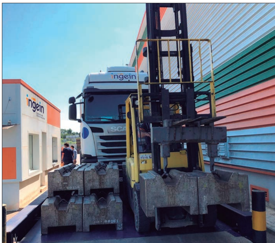
La ICT 155 obliga a que la báscula no pueda pesar más allá del máximo especificado en la etiqueta de limitación.
