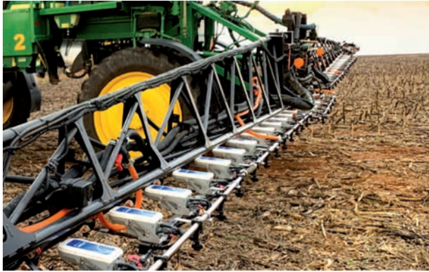
Foto 2. Detalle del montaje de un sistema WeedSeeker 2 por cada boquilla.
