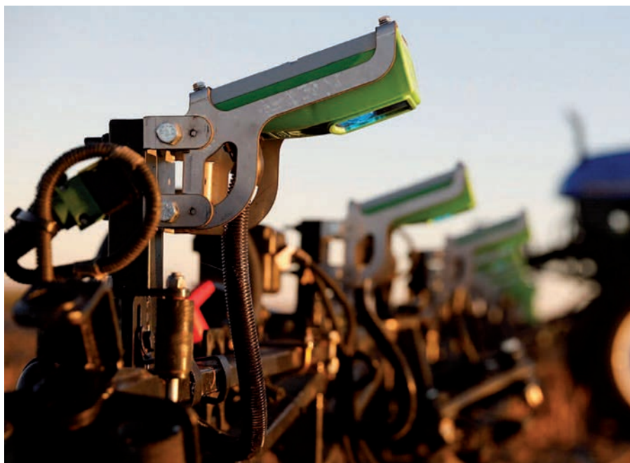
Foto 1. Detalle del sistema de sujeción del sistema Weed-it Quadro.
