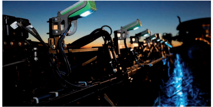
Foto 3. Detalle de la iluminación con luz azul en el Weed-it Quadro para producir la fluorescencia de la clorofila.
