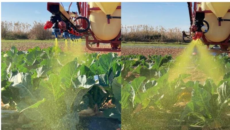
Estudios recientes efectuados por el grupo de mecanización agraria de la UPC (UMA-UPC), en colaboración con asociaciones de defensa vegetal, han demostrado que usando boquillas antideriva se pueden controlar las plagas con un **ahorro del 40 % de producto con un equipo correctamente calibrado**.
